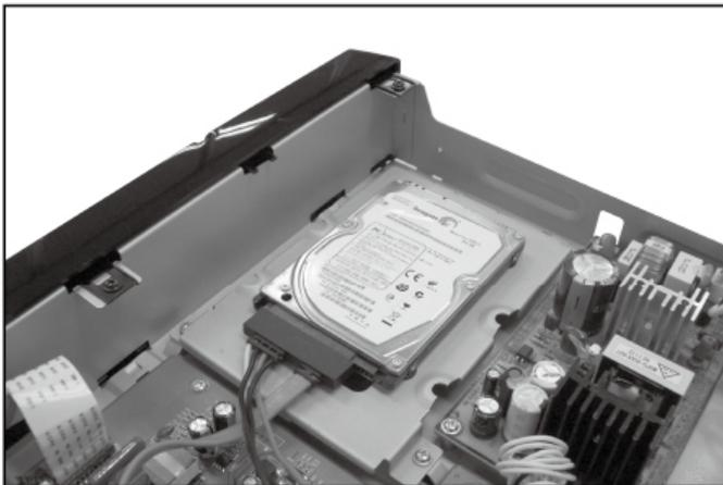
Ansicht mit eingebauter 2.5" HDD.
