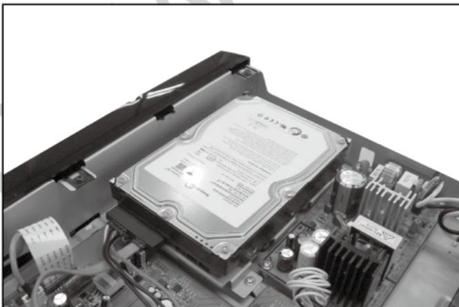
Ansicht mit eingebauter 3.5" HDD.
